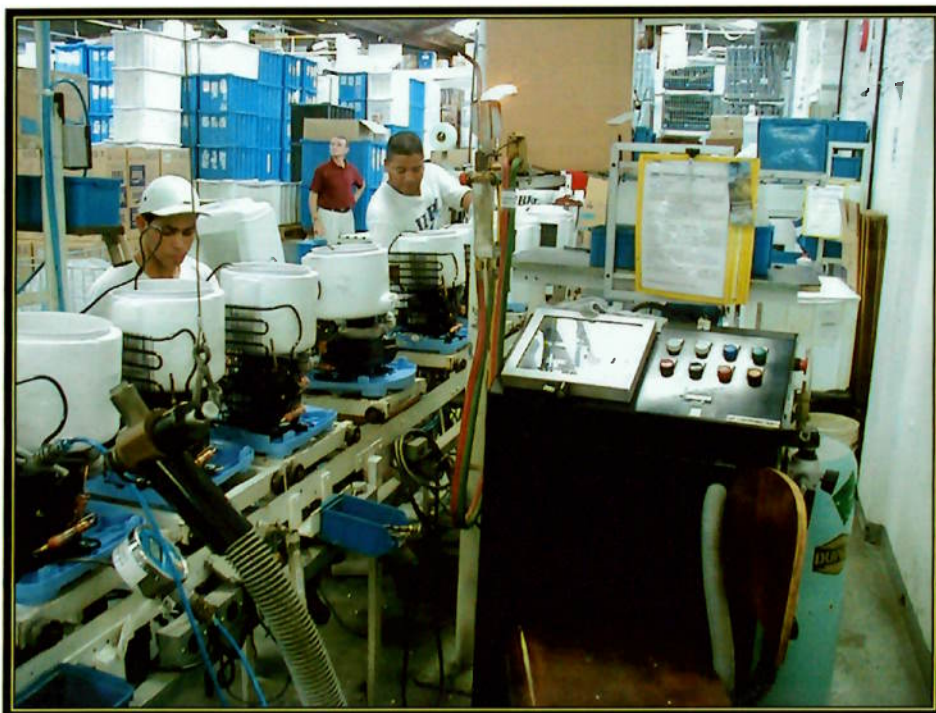
Figura 10 – Estação de Carga de Gás Refrigerante
