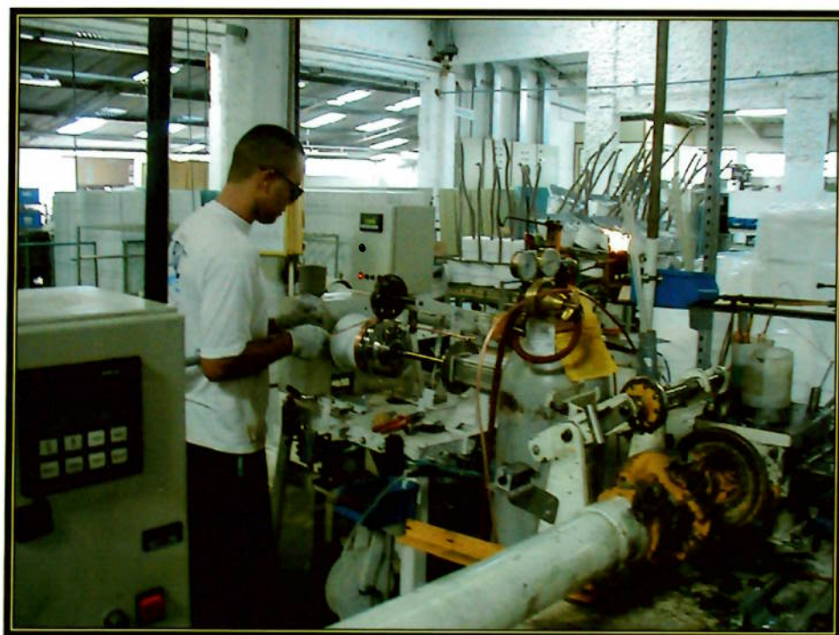
Figura 13 – Montagem do Evaporador
